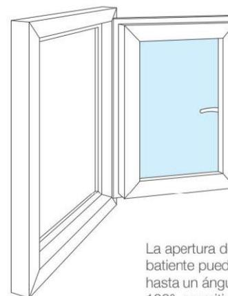
La apertura del sistema batiente puede abarcar hasta un ángulo de 180°, permitiendo la accesibilidad total a la hoja para facilitar la limpieza.
